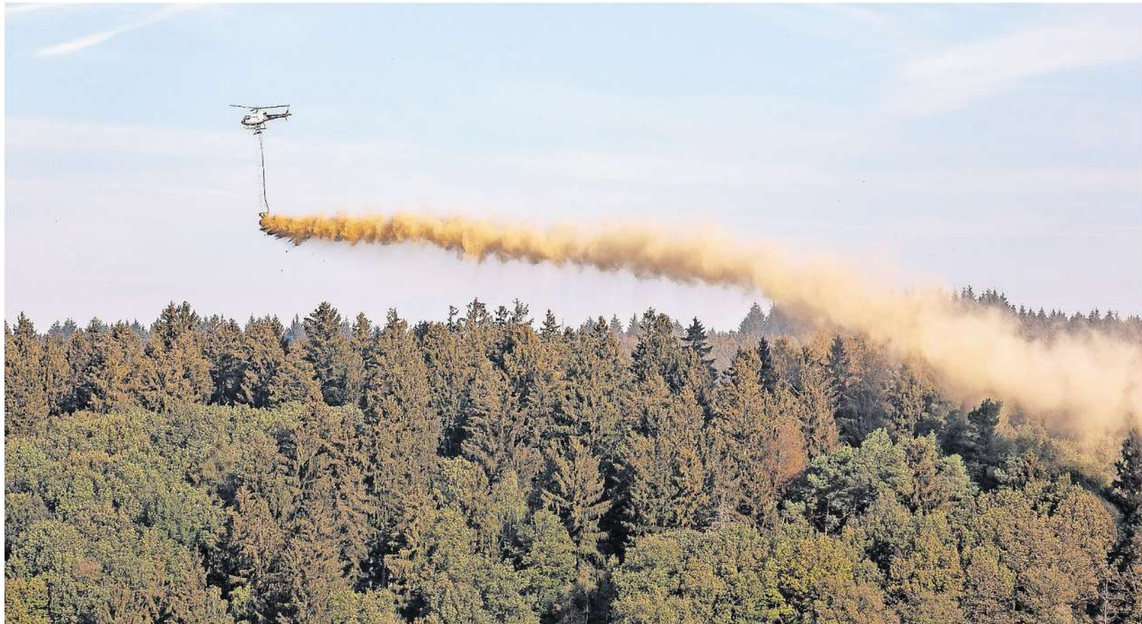
Über den Wipfeln der Bäume: Die Kalkung der Böden im Simmerather Gemeindewald erfolgt aus der Luft. Ein Hubschrauber ist seit Montag dafür im Einsatz. Betroffene Flächen werden durch Wegesperrung kenntlich gemacht und sollten nicht betreten werden.
