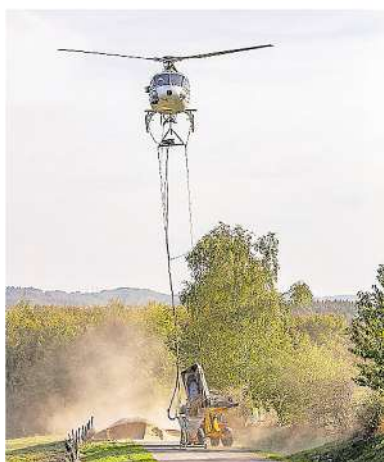
Über einem Feldweg schwebend, lässt der Hubschrauber den Behälter zu Boden, wo ein Radlader ihn rasch wieder mit Kalk befüllt.
